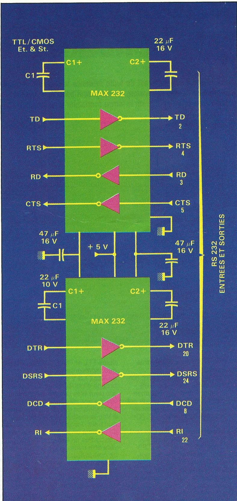
Le MAX 232, en effet, intègre deux pompes de charges, pour implémenter essentiellement les normes d'émissions RS 232C. La première pompe de charges utilise le diélectrique externe C1 pour transformer en + 10 V les + 5 V qu'on lui a appliquées sur la broche 16. L'impédance de sortie résultante atteint environ 200 ohms si la valeur de C1 vaut 22 microfarads.
