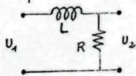
De plus ces courbes sont valables pour un filtre passe-bas RL à résistance et inductance à condition de poser  $\omega_c = \frac{R}{L}$
