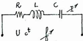
A la résonance on a un minimum d'impédance ( $Z_0 = R$ ) et un maximum de courant ( $I_0$ )
