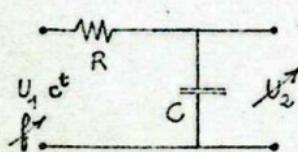
la tension  $U_1$  d'amplitude constante et de fréquence variable se répartit, proportionnellement aux impédances, entre  $R$  et  $C$ . Lorsque  $f \rightarrow \infty$   $1/C\omega \rightarrow 0$  et  $U_2 \rightarrow 0$  (les hautes fréquences ne passent pas). Lorsque  $f \rightarrow 0$   $1/C\omega \rightarrow \infty$   $U_2 \rightarrow U_1$  (les basses fréquences passent). Il s'agit bien d'un filtre passe-bas (bien qu'il soit peu efficace comme on le verra plus loin).
