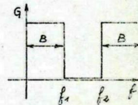
$f_1$  et  $f_2$  sont les fréquences de coupure idéales.
