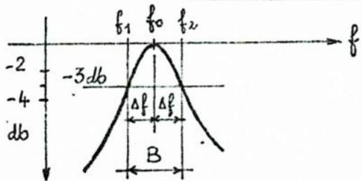
Il y a 2 fréquences atténueres de 3 dB par rapport à  $f_0$ . Pour ces fréquences on a  $\frac{U_0}{U} = \sqrt{2}$  donc  $S = \sqrt{2}$
