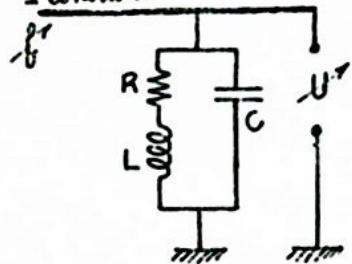
Considérons un circuit RLC parallèle alimenté par un courant d'amplitude constante et de fréquence variable.
